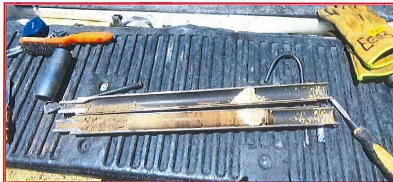
Fotografías 3 : Recuperación de muestra alterada mediante tubo partido.
