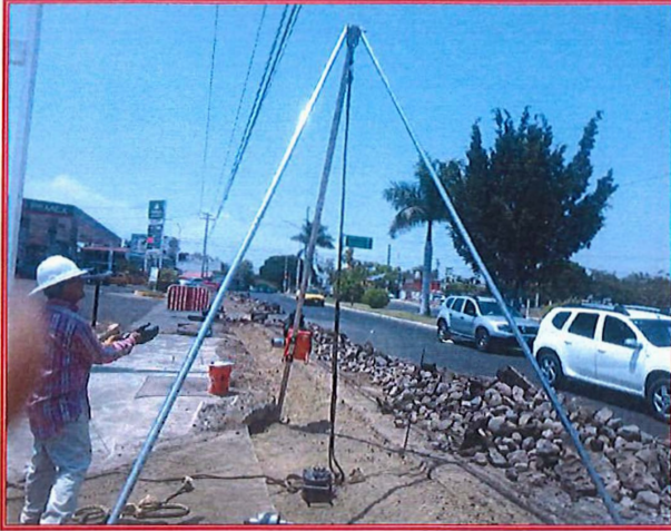
Fotografías 1 y 2 : Realización de los sondeos exploratorios SPT.
