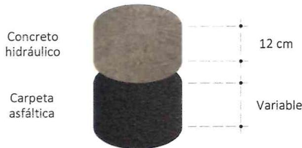
Figura 5 | Sección de pavimento de la estructura propuesta.
